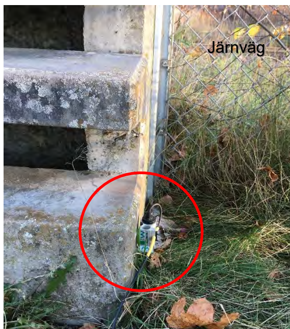
Bild 3. Mätarmontage vid referensmätpunkt för tågtrafik
